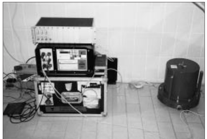
Registrierungen eines Vogtland-Erdbebens am 6.11.2000, 22:07 Uhr an Stationen des Deutschen Seismologischen Regionalnetzes (Dreiecke). Aus den unterschiedlichen Schwingungsformen können die Seismologen Rückschlüsse auf Bruchvorgänge im Erdbebenherd ziehen. (Abb. links) Aufzeichnungsapparatur in einem Wasserhochbehälter in der Nähe von Wernitzgrün. Das Gerät rechts ist das Seismometer, mit dem kleinste Bewegungen des Erdbodens gemessen werden. Die übrigen Geräte dienen der digitalen Datenaufzeichnung.
